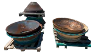
Piezas desgastadas para su reciclaje en una de nuestras fundiciones Magotteaux!
